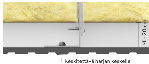
Kuva 2. Swisspearl Patina Inline -levyn asennus L -profiiliin.
