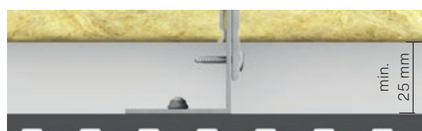
Rys. 2. Montaż Swisspearl Patina Inline na profilu „L”
