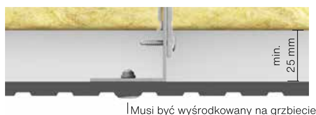
Rys. 2. Montaż Swisspearl Patina Inline na profilu „L”
