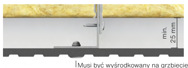
Rys. 2. Montaż Swisspearl Patina NXT Inline na profilu „L”
