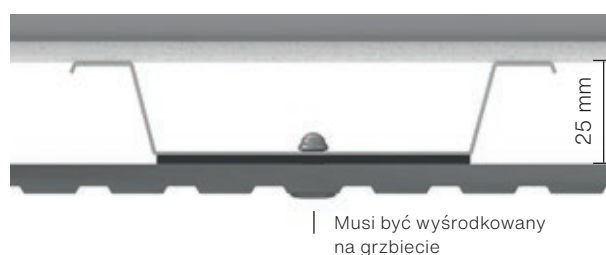
Rys. 2. Montaż Swisspearl Patina Inline na profilu środkowym
