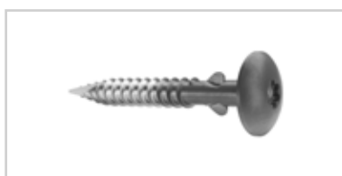
Wkręt fasadowy motylkowy Swisspearl do drewna bez podkładki SCR-WW 4,9×38 mm Stal nierdzewna A2 (Swisspearl Patina i Swisspearl Construction)
