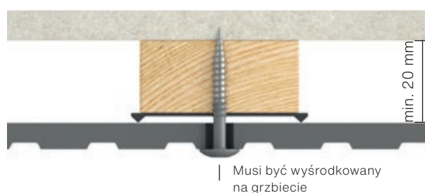
Rys. 2. Montaż Swisspearl Patina Inline na łącie środkowej
