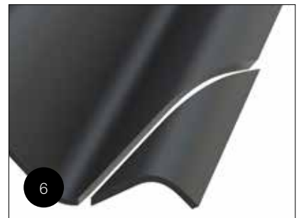
6 FK plader langs venstre vindskede. Tildanning af hjørneafskæringen. Se side 18.
