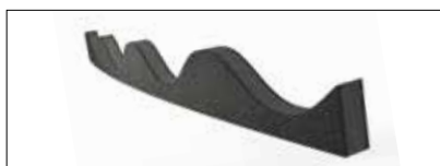
Swisspearl Asfaltimpregnerede Skumbølgeklodser Til grat, skotrende og tagryg. Kan anvendes både under og over bølgepladerne (ventilerer ikke tagrum).
