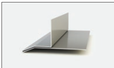
8. Swisspearl Lysningsprofil, vandret (stor) 40 x 50 x 40 mm farvet aluminiumsprofil til vandret afslutning over induer og døre.
