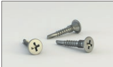
Swisspearl 27 Universalskrue 3.9 x 27 mm Zytex GX – Til skjult montering på stålunderstøtning. Fås også som skruer på bånd.
