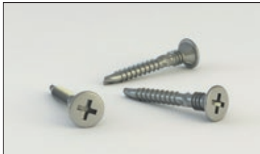
Swisspearl 38 Universalskrue 3.9 x 38 mm Zytex GX – Til skjult montering på træunderstøtning. Fås også som skruer på bånd.
