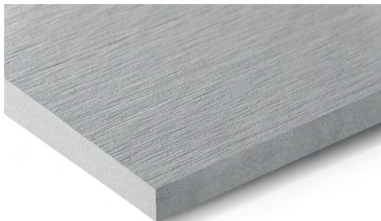
Vintago est un panneau en fibres-ciment à séchage naturel qui séduit par sa surface poncée et légèrement rugueuse. Le procédé de polissage à l'aide d'un abrasif à gros grain transpose subtilement l'intérieur et l'originalité du panneau en fibres-ciment à l'extérieur. La texture robuste des panneaux en fibres-ciment qui en résulte perturbe les surfaces homogènes sans être gênante.
