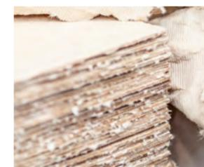
Notre fibres-ciment se compose de ciment, de pulpe, d'eau, de fibres plastiques et d'air. La combinaison de ces ingrédients permet d'obtenir un matériau de construction durable, mais aussi léger par rapport à d'autres matériaux en ciment. Au toucher, le matériau révèle sa nature homogène et la qualité de sa surface. Son aspect souligne son caractère unique et sa texture naturelle.
