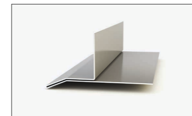
7. Swisspearl Lysningsprofil, vandret (stor) 40 x 50 x 40 mm farvet aluminiumsprofil til vandret afslutning over vinduer og døre.
