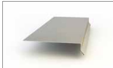
5. Swisspearl Sålbænkprofil 25 x 125 mm farvet aluminiumsprofil til afslutning under vinduer.
