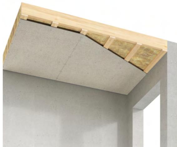
Die herkömmliche Montage der Swisspearl Multi Force erfolgt mit Schrauben, aber bei Bedarf kann die Befestigung auch mit Druckluftnagler (Nägeln/ Klammern) erfolgen.
