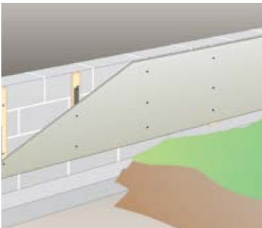
Platen kan monteres som enkel sokkelplate, direkte på grunnmuren men luftet. Swisspearl Construction benyttes også til prefabrikkerte grunnmurselementer.
