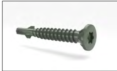
Swisspearl Universal 30, kirkas SCR-S 4,2x30 mm piilokiinnitys teräsrankaan (1,2–3,0mm)
