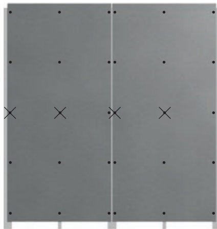
Eksempel: Vertikalt monterte plater med en mellomliggende aluminiumsprofil.
