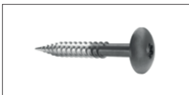
Swisspearl Fasadeskrue til tre SCR-W 4.5x30 /36 /41mm A2 rustfritt stål
