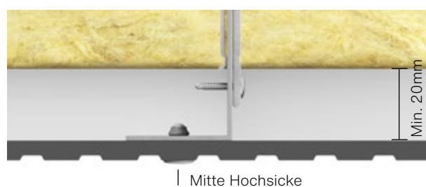
Abb. 2. Swisspearl Patina Inline NXT – Befestigung auf L-Tragprofil
