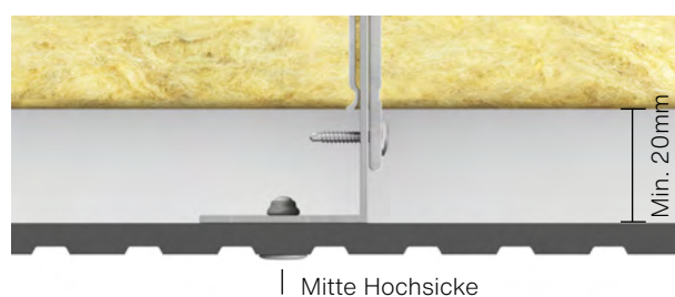
Abb. 2. Swisspearl Patina Inline NXT – Befestigung auf L-Tragprofil
