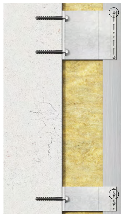
Die rot markierten Wandhalter (F) zeigen beispielhaft die Position der Festpunkte der Tragprofile. Allen anderen Befestigungen an den Konsolen sind als Gleitpunkte (G) auszuführen.
