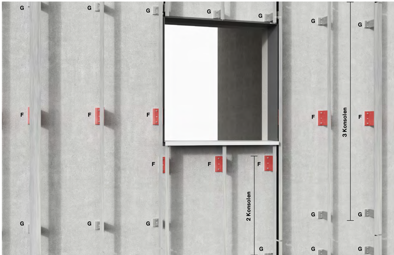
Die rot markierten Wandhalter (F) zeigen beispielhaft die Position der Festpunkte der Tragprofile. Allen anderen Befestigungen an den Konsolen sind als Gleitpunkte (G) auszuführen.
