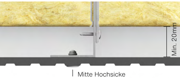
Abb. 2. Swisspearl Patina Inline NXT – Befestigung auf L-Tragprofil
