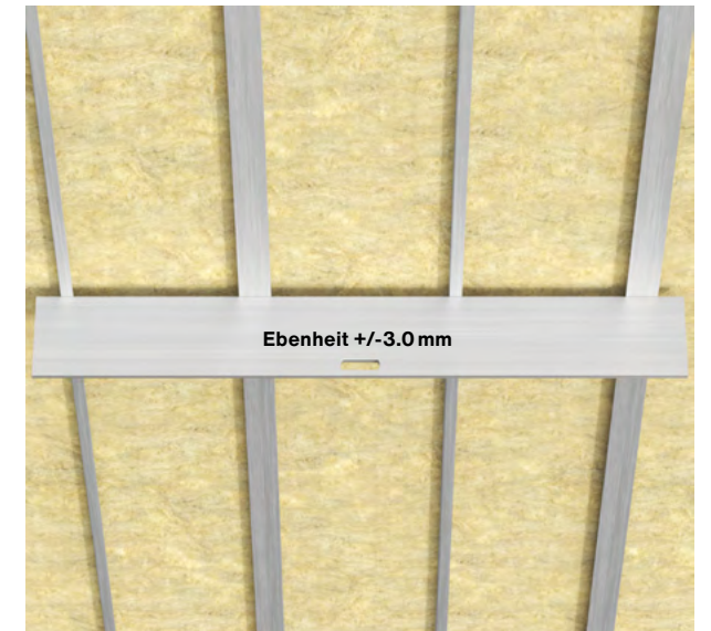
Planheit der Unterkonstruktion
