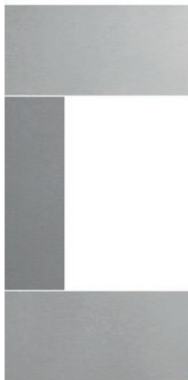
Richtige Anordnung von Swisspearl Fassadentafeln bei Fenstern, Türen und anderen Öffnungen
