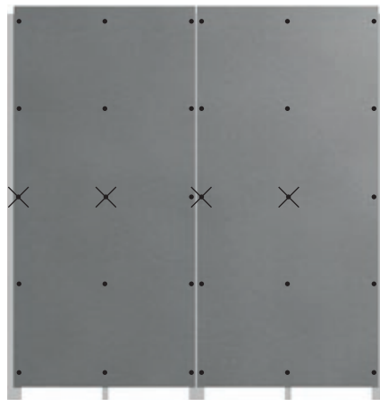
Beispiel: vertikal montierte Tafeln mit 1 mittlerem Alu L-Tragprofil
