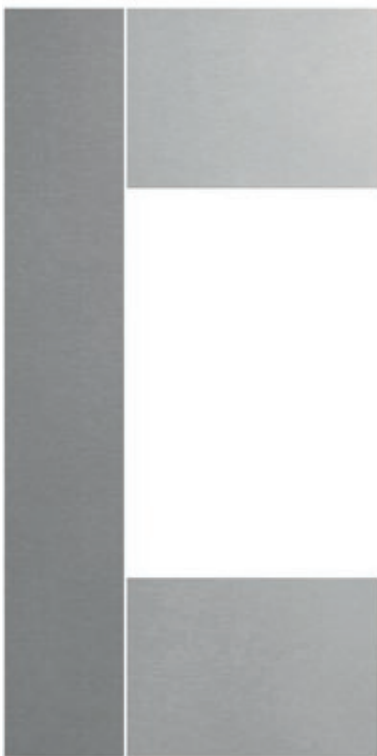
Richtige Anordnung von Swisspearl Fassadentafeln bei Fenstern, Türen und anderen Öffnungen
