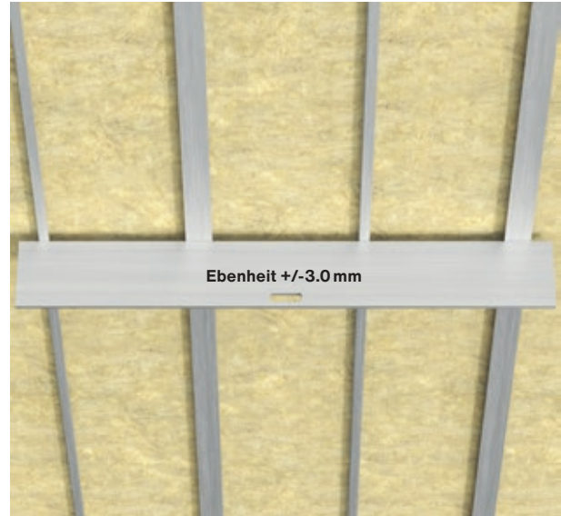
Planheit der Unterkonstruktion
