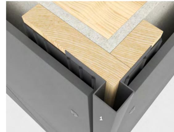
Swisspearl Außeneckenprofile werden für 90° Außenecken verwendet. Die Außenecken werden mit Schrauben in vorgebohrte Ø4 mm Löcher befestigt. Die Fassadentafeln halten die Außenecke in der richtigen Position, wobei das Profil sich frei ausdehnen kann. Es sollte ein Mindestabstand von 4mm zwischen den Tafelkanten und dem Profil, bestehen.
