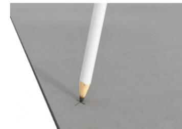
Stellen Sie bei der Markierung der Bohrlöcher oder Schnittkanten auf der Tafel sicher, dass diese kleiner sind als der Bohrer, bzw. schmaler als das Sägeblatt. Nachträgliches Entfernen kann zu Beschädigungen der Tafel führen.
