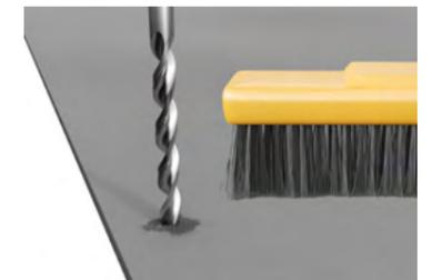
Staub vom Schneiden oder Bohren muss gleich entfernt werden, da sonst Spuren auf der Oberfläche zurück bleiben können.
