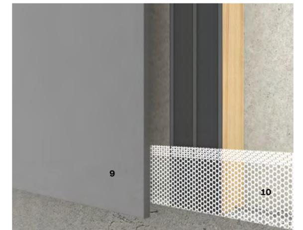
Swisspearl Abtropfkante leitet Wasser von der Fassade zu einer vorspringenden Kante, von der das Wasser abtropfen kann. Das Profil kann in Verbindung mit dem Lüftungsgitter eingesetzt werden um zu verhindern, das Nager und Kleintiere in den Hohlraum hinter den Fassadentafeln gelangen. Die Fuge zwischen der Fassadentafel und dem Profil soll mindestens 4mm betragen.
