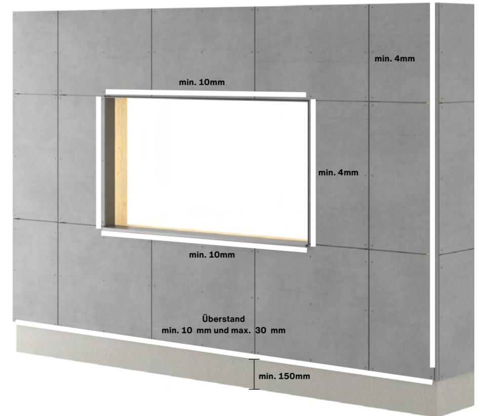
Beachten Sie unbedingt die vorgegeben Abstände in diesem Handbuch. Die Fassadentafel sollte zwischen 10 und 30 mm unterhalb der Unterkonstruktion überstehen.
