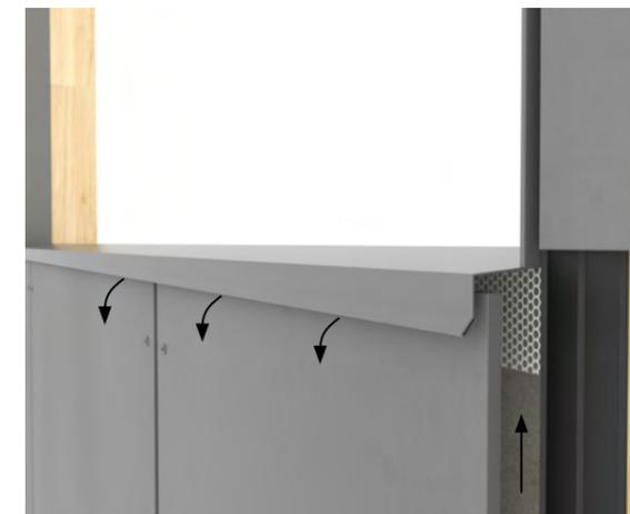
Unter den Fensterbänken ist ebenso ein Mindestabstand von 10 mm oder 50 cm<sup>2</sup> pro Meter einzuhalten. Der Lüftungsspalt wird zwischen der oberen Kante der Fassadentafel und der Unterkante der Fensterbank gebildet. Es wird empfohlen, die Tropfkante/Wassernase mindestens 30 mm vor die Fassadenfläche zu setzen. Dieser Aufbau stellt sicher, das abfließendes Wasser vom Fenster nicht in die Unterkonstruktion/hinter die Fassadentafeln läuft.
