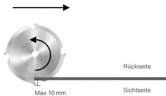
Beim Einsatz einer Handkreissäge schneiden Sie auf der Rückseite der Platte.
