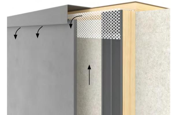
Die Lüftungsöffnung muss am oberen Ende der Fassade eingehalten werden. Genau wie am Sockel muss ein Lüftungsspalt von mindestens 10 mm oder 50 cm<sup>2</sup> pro Meter gewährleistet sein.
