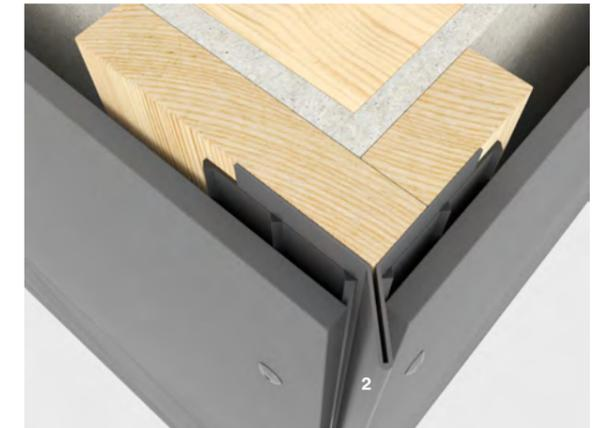
Swisspearl Y-Außeneckprofil kann ebenso für 90° Außenecken verwendet werden. Es wird wie das Außeneckenprofil mit Schrauben montiert. Der Abstand von der Innenkante der Fassadentafeln zum Profil sollte mindestens 2mm betragen.
