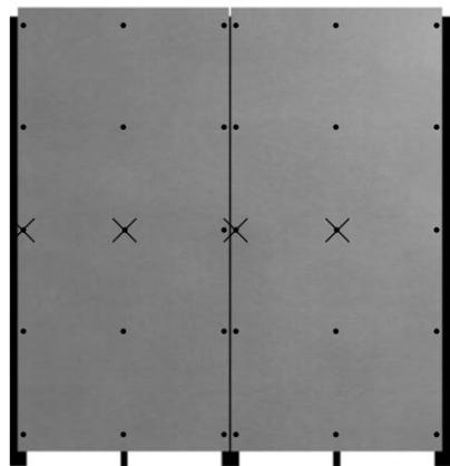
Beispiel: Vertikal montierte Tafeln mit einer Mittellatte
