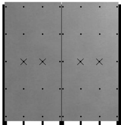
Beispiel: Vertikal montierte Tafeln mit 2 Zwischenlatten.
