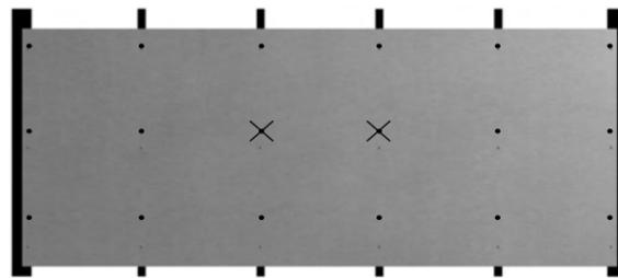
Beispiel: Horizontal montierte Tafeln mit vier Zwischenlatten
