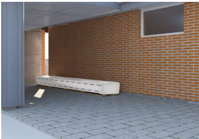
Bei einer Lagerungszeit an der Baustelle von mehr als 2-3 Wochen sollte das Produkt unter einer Überdachung gelagert werden. Es können maximal 8 Swisspearl Plank Original Paletten übereinander gestapelt werden.
