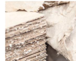
Unser Faserzement besteht aus Zement, Zellstoff, Wasser, Kunststofffasern und Luft. Die Kombination dieser Inhaltsstoffe ergibt ein langlebiges und im Vergleich zu anderen Zementbaustoffen, leichtes Baumaterial. In der Hand zeigt der Werkstoff seine homogene Materialität und Oberflächenqualität. Dem Auge präsentiert er sich mit seinem einzigartigen Charakter und seiner natürlichen Textur.
