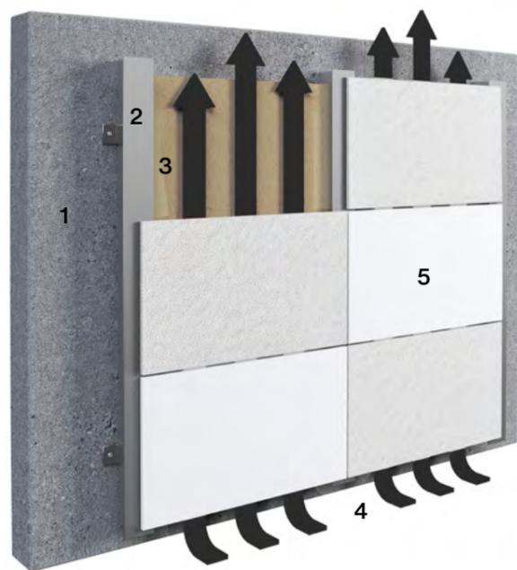
1 Tragwerk, 2 Unterkonstruktion, 3 Wärmedämmung, 4 Hinterlüftungsraum, 5 Swisspearl Faserzementplatte
