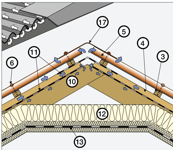
Větrání střechy hřebenovým úhelníkem,  $250 \text{ cm}^2/\text{m}$  - A5
