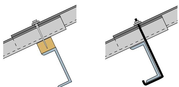
4. Ocelové vaznice - montáž pomocí šroubů
