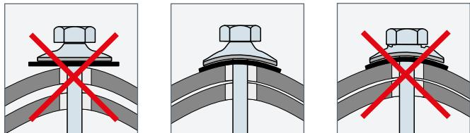
1. Správné dotažení upevnovacích šroubů
