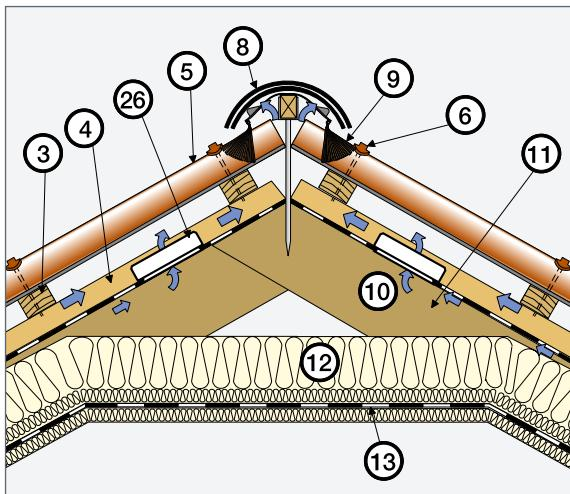
Větrání střechy hřebenem, použití ventilačního prostupu folií,  $100 \text{ cm}^2/\text{m}$
