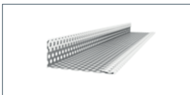
10. Swisspearl ventilační profil , vyrobeno z perforovaného ocelového plechu tl. 0.6 mm, délka 3000 mm. Minimální šířka větrané mezery v případě použití mřížky je 40 mm.
