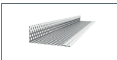
7. Swisspearl ventilační profil, vyrobeno z perforovaného ocelového plechu tl. 0.6 mm, délka 3000 mm. Minimální šířka větrané mezery v případě použití mřížky je 40 mm
