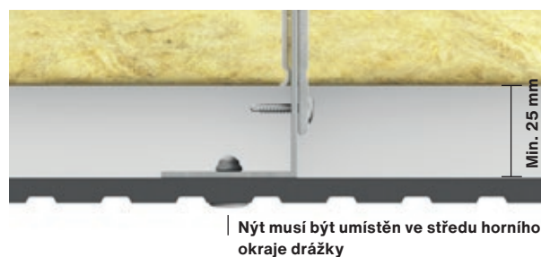
Obr. 2. Horizontální řez kotevním prvkem ve středu desky
