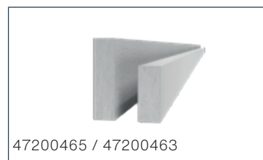
12. Swisspearl Trim 25 x 65/90 mm trim i fibersement. Med trestruktur/glatt overflate OBS! Levers malt kun på den glatte siden. Siden med trestruktur må males ved utenpåliggende montasje.
