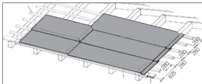
Verlegung auf Lattung: Bei Rastermassen, die mit den Abmessungen der Meteo-Unterdachplatten nicht übereinstimmen, können diese auf einen Lattenrost mind. 24 x 48 mm verlegt werden. Der Lattenabstand beträgt 280 mm. Die Platten werden bündig OK Lattung verlegt.
