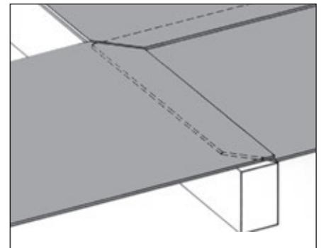
Eine einwandfreie Überdeckung beim Kreuzpunkt von vier Platten wird durch die im Werk vorgefertigten Eckschnitte gewährleistet.
