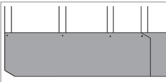
Die Meteo-Unterdachplatten werden auf jedem Sparren bzw. auf jeder Konterlatte mit einem Breitkopfstift 2,5 x 35 mm befestigt.
