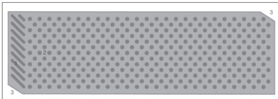
Die Meteo-Unterdachplatte: 1 Sicken 2 Noppen 3 Vorgefertigte Eckenschnitte
