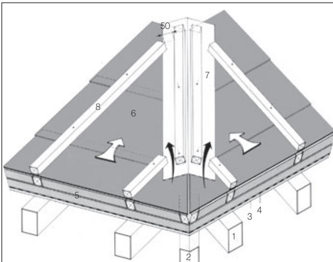
Zweifach belüftete Konstruktion
