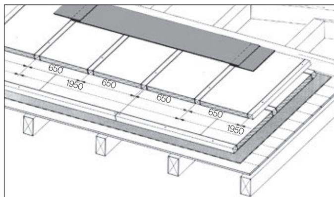
Verlegung der Meteo-Unterdachplatte unabhängig von der Sparreneinteilung. Lattenabstand 650 mm (Breite der Wärmedämmung 600 mm abzüglich Klemmass 5 mm zuzüglich Lattenbreite 55 mm). Plattenformat 2050 x 625 mm, Rastermass  $y = 1950$  mm, einheitlicher Sparrenabstand = 650 mm
