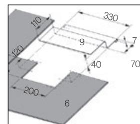
Lüftungshaube zur Be- und Entlüftung von zweifach belüfteten Konstruktionen
