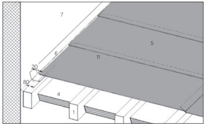
Wandanschluss gedichtet mit Winkelblech. Der Wandanschluss ist auch mit Meteo-Dichtungsband möglich. Die Ecken der Meteo-Unterdachplatte werden oben im Winkel von 45° bis Ende Falz gestutzt.
