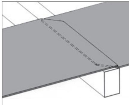
Die Verlegung kann horizontal oder vertikal erfolgen. Die mittlere seitliche Überdeckung beträgt 100 mm, kann jedoch zwischen mind. 90 mm und max. 110 mm variiert werden. Bei grösserer Überdeckung können die Platten an den Ecken nachgeschnitten werden.
