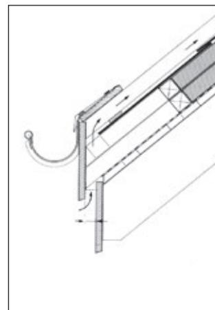
Bei der Einteilung ist die Belüftung zu berücksichtigen. Der Lufttritt muss gemäss Norm SIA dimensioniert sein.
