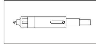
Bohrlehre 9541-2 mit integriertem Bohrer
