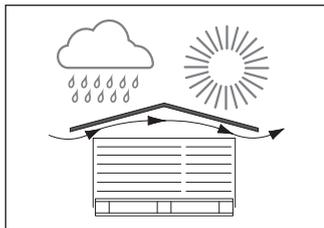
Stapel unter Dach oder mit Blache abgedeckt vor Nässe und direkter Sonneneinstrahlung schützen. Die Schutzfolie allein genügt nicht.
