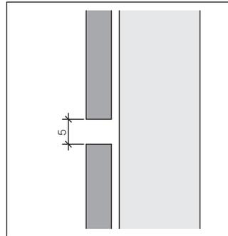
**Vertikalfugen offen min. 5 mm**
