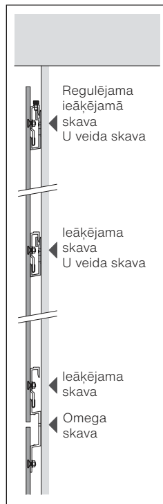
Fasādes nobeigums ēkas augšdaļā
