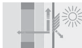
Poleti se del toplote odvede z zračenjem.
