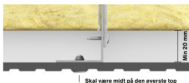
Fig. 2. Installation af Swisspearl Patina Inline på L-profil.
