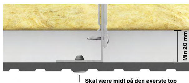
Fig. 2. Installation af Swisspearl Patina Inline på L-profil.
