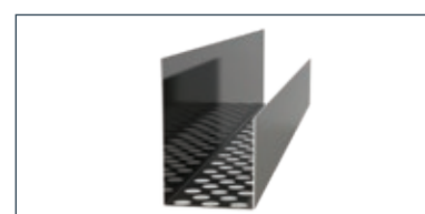
12. Swisspearl Profil 40, Montageprofil 25 x 40 mm vandret ventilation, startunderstøtninger, start-slut profil, 0.7 mm tykkelse
