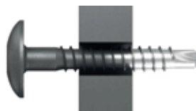
Fikspunktets hul diameter \varnothing 5 mm. Ved skruer med spændeskive fjernes spændeskiven før montering i fikspunkter.
