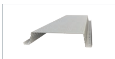
11. Swisspearl Profil 70/100, Montageprofil 25x70 mm / 25x100 mm, 0,7/1 mm tykkelse. Profil 100 anvendes ved pladesamlinger
