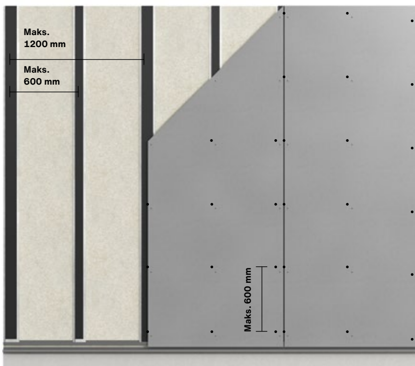
Swisspearl Facadeplader monteret på lodrette Swisspearl Montageprofiler
