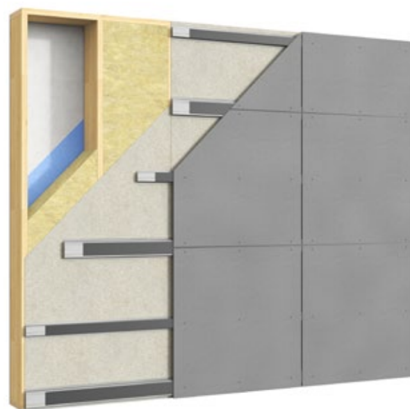
Letvæg med vandret Swisspearl Montageprofiler
