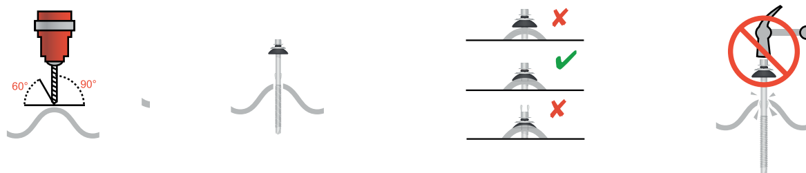
Fig 6.3 - Bevestiging boutgaten en positie
