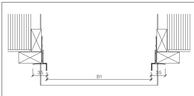
5. Définition de la largeur du profilé de linteau
