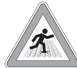
Les plaques ondulées Ondapress-57 sont à considérer comme non résistants à la rupture.
