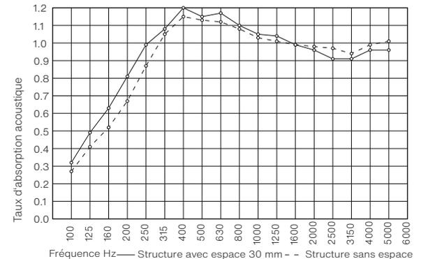
**Perforation 16x24x8 mm****Fentes 4 mm,****profondeur 6 mm**
