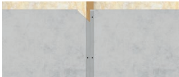
Voegen van afgezaagde panelen moeten worden afgeplakt
