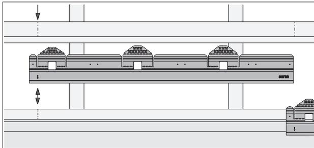
Die Startleisten werden auf die vertikale Schnürung ausgerichtet und mit drei Nägeln 35 mm befestigt.
