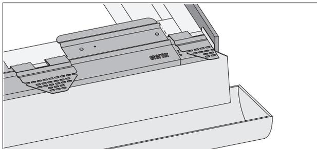
Wenn der rechte Ort mit einer ganzen Structa Platte eingeteilt ist, muss zusätzlich ein Abschnitt einer Startleiste unterlegt werden.
