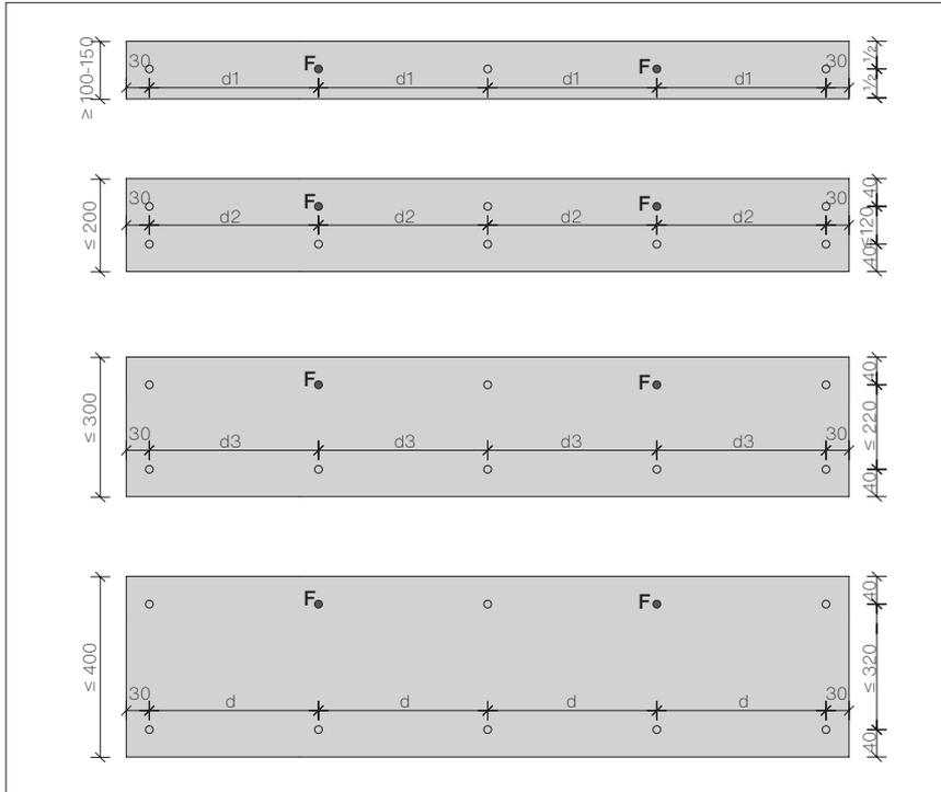
Bei einer Plattenhöhe von  $\leq 400$  mm darf der horizontale Randabstand min. 30 mm und der vertikale min. 40 mm betragen. Bei einer vertikalen Streifenanordnung beträgt der horizontale Randabstand min. 30 mm und der vertikale min. 80 mm.
