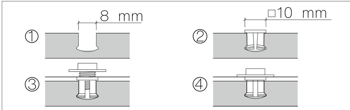
1 Bohrloch mit Hinterschneidung
