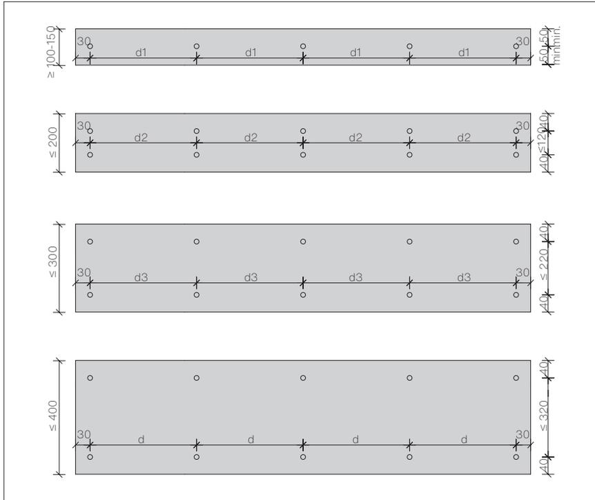
Bei einer Plattenhöhe von  $\leq 400$  mm darf der horizontale Randabstand min. 30 mm und vertikale min. 40 mm betragen. Bei einer vertikalen Streifenanordnung beträgt der horizontale Randabstand min. 30 mm und vertikale min. 80 mm.
