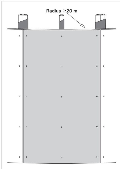
Largo stehend verlegt, minimaler Radius 20 m. Die Traglattung vertikal unter dem Plattenstoß, mit 2x60 mm Lattenbreite ausbilden. Die Traglattung mit 2 Schrauben je Befestigungsstelle befestigen.
