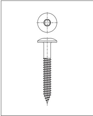
Fassadenschraube, Flachrundkopf Ø 12 mm, T20 4,8x38 mm.
