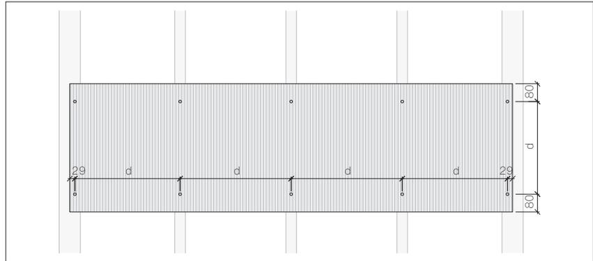
Bohrlöcher  $\varnothing$  5,5 mm
