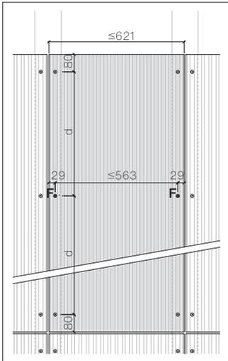
Die maximale Befestigungsdistanz der Einfeldplatten beträgt 563 mm. Ergeben sich aus dem Standort, der Gebäudehöhe und Referenzwinddruck/-sog kleinere Werte, sind diese zu verwenden. Der Abstand [d] ist aus der
