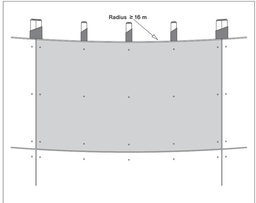
Largo liegend verlegt, minimaler Radius 16 m. Die Traglattung vertikal unter dem Plattenstoß, mit 2x60 mm Lattenbreite ausbilden. Der maximale Abstand der Zwischenlatten beträgt 620 mm. Die Traglattung mit 2 Schrauben je Befestigungsstelle befestigen. Sonderformteile (Eckwinkel) sind für gewisse Oberflächen mit kleineren Radien ( $r > 250$  mm) herstellbar.
