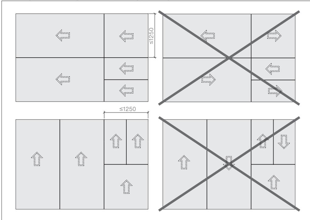
Die Pfeilmarkierungen der Reflex-, Vintago- und Design-Platten müssen in gleicher Richtung angeordnet werden. Um Montagefehler zu vermeiden, ist die Pfeilrichtung wie folgt zu beachten:
