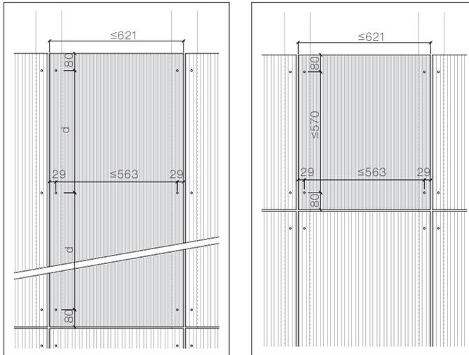
Die maximale Befestigungsdistanz der Einfeldplatten beträgt 563 mm. Ergeben sich aus dem Standort, der Gebäudehöhe und Referenzwinddruck/-sog kleinere Werte, sind diese zu verwenden. Der Abstand [d] ist aus der Tabelle «Befestigungsdistanzen» ersichtlich (Einfeldplatte = Maß [d] plus Randabstand 2x29 mm).
