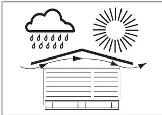
Stapel unter Dach oder mit Plane abgedeckt vor Nässe und direkter Sonneneinstrahlung schützen. Die Schutzfolie allein genügt nicht.
