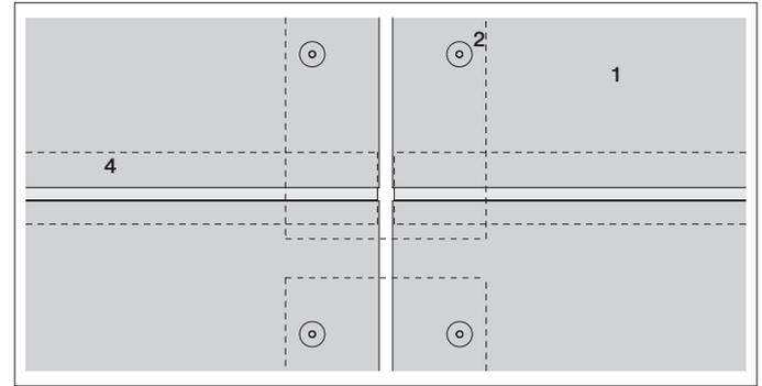
Die Stöße von Tragprofilen dürfen nur bei den Plattenstößen angeordnet werden. Durch Einschneiden und Abbiegen wird das Wandern der Fugenbleche verhindert.
