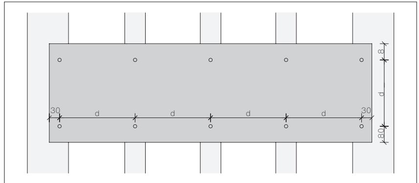
Bohrlöcher  $\varnothing$  5,5 mm
