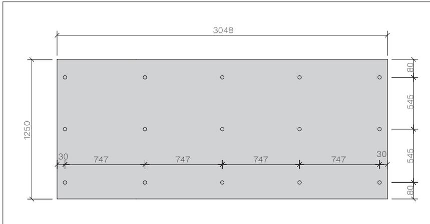
Durch spezielle Optimierung kann eventuell eine vertikale Befestigungsreihe eingespart werden.
