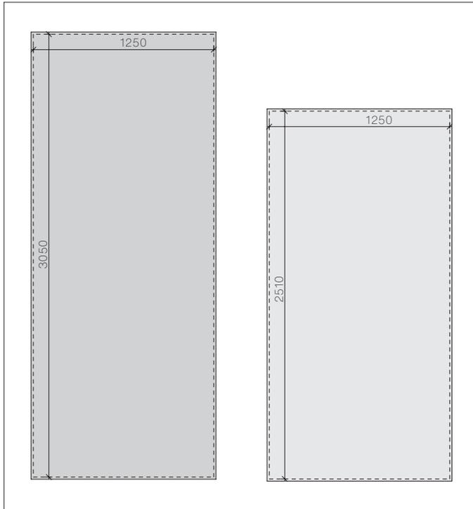
Plattendicke 8 und 12 mm: Maximale Nutzformate [mm]
