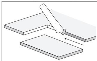
Kanten von Schnitten und Ausschnitten auf der Baustelle müssen mit Kantenimprägnierungsmittel oder bei Largo Purio Fassadenplatten mit Purio Imprägnierungsmittel behandelt werden.
