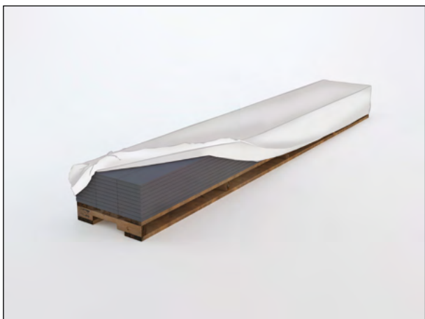
För att minska utfällningen av kalk på produktens yta ska du ta bort plastförpackningen omedelbart vid leveransen till byggarbetsplatsen.
