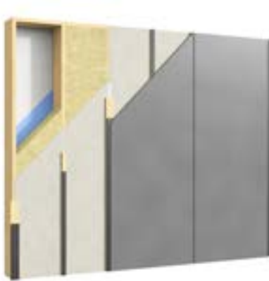
Exempel på en lätt väggkonstruktion med en A1-klassad Swisspearl Windstopper Extreme 9,0 mm som också har en täckningsklass på K1 10 B-s1,d0
