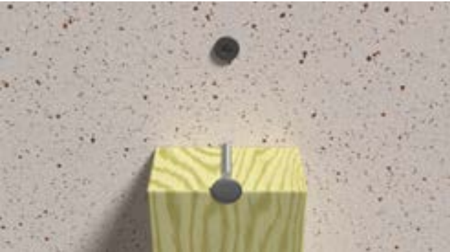
För mittläkt, se till att du inte placerar spikarna för nära kanten på den underliggande konstruktionen
