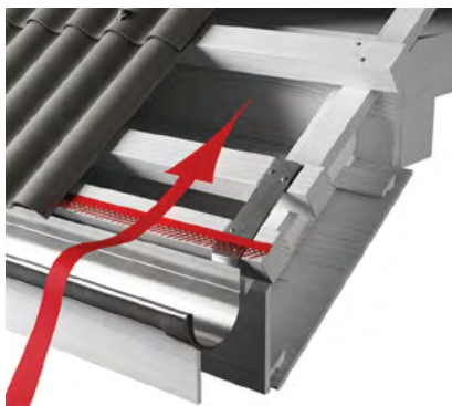
5 pav. Stogo karnizas – vėdinimo angų plotas viename tiesiniame metre: lakštai W130-9 – 120 cm 2 ;
