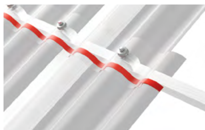
30 pav. Dviejų skaidrių lakštų „Eurolux“ jungimas, skersinė užlaida.
