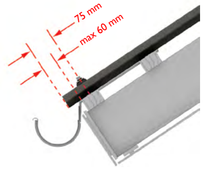
20 pav. Atstumas nuo tvirtinimo taško iki lakšto apatinės briaunos 75 mm.
