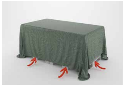
Vēlāk izstrādājumi jānoliek uz gludas un sausas virsmas, bet krautne jāapklāj ar tentu vai brezen-tu, kas pasargās no nokrišņiem un nodrošinās vēdināšanu apkārt paletei.
