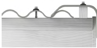
40. att. Vējmalas ar liektu malu montāža.
