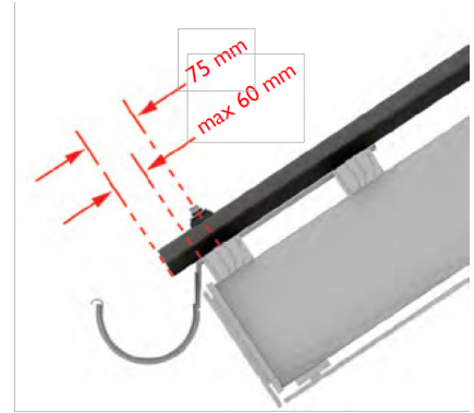
20. att. Attālumam no lokšnes gala līdz stiprinājuma punktam ir jābūt ne mazākam par 75 mm.
