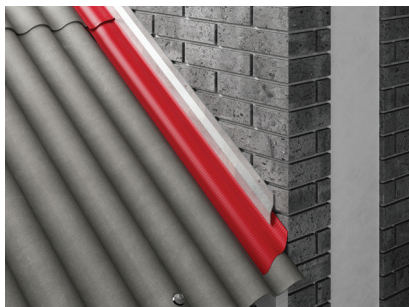
Joonis 45. Katuseviilu ja hoone seinä ühenduskoha ehitamine.
