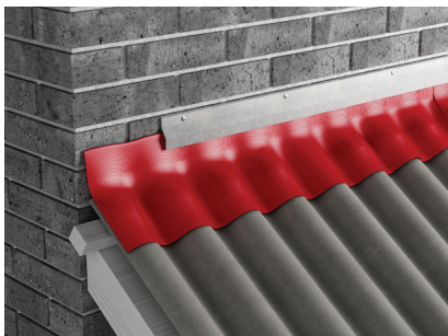
Joonis 44. Katuseviilu ja hoone seinä ühenduskoha ehitamine.
