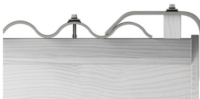
Joonis 40. Painutatud servaga tuulelaua paigaldamine.
